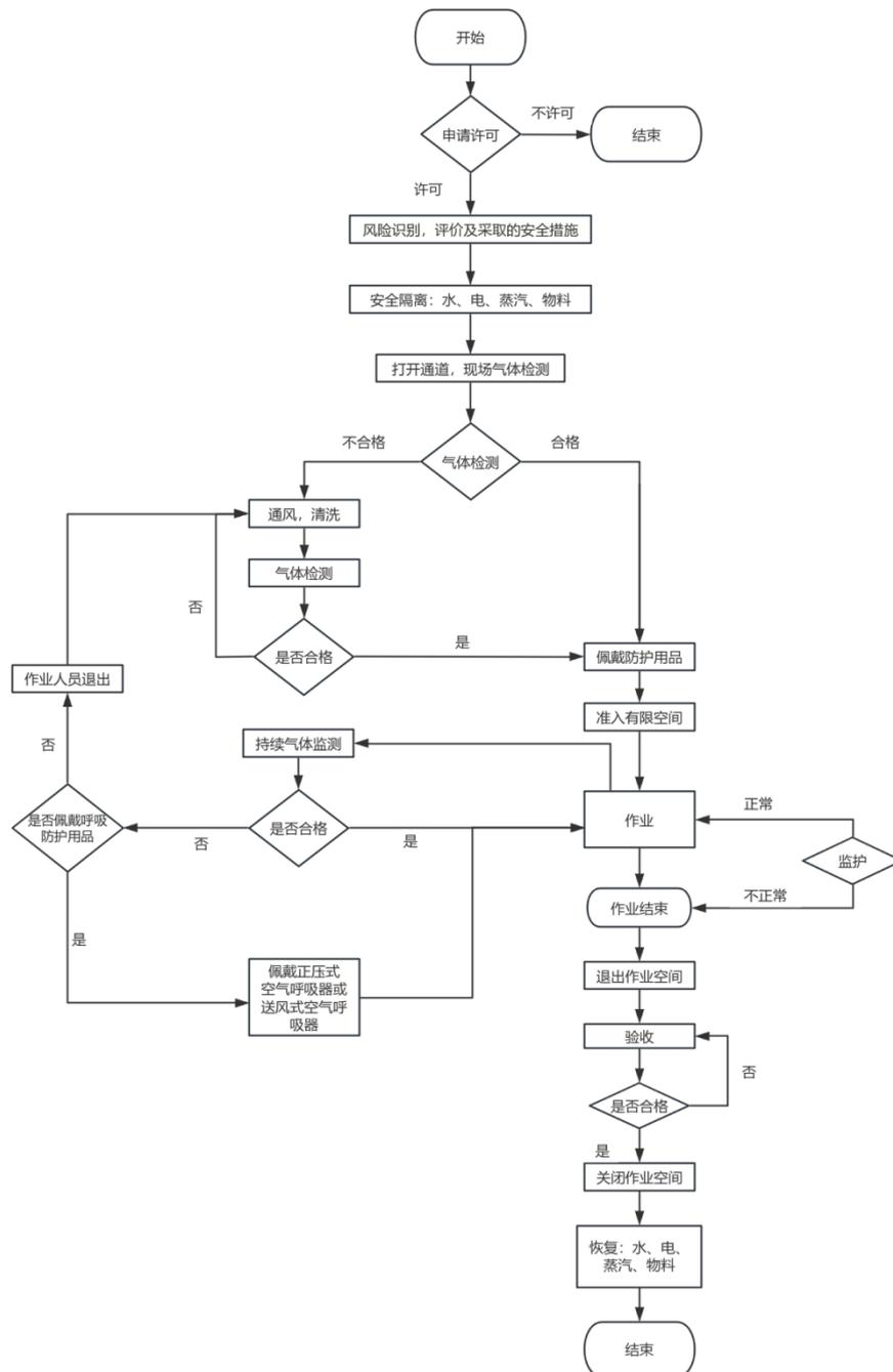
图A.1 进入有限空间作业流程图
